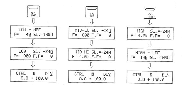
A l'aide des touches de CURSOR  $\triangleleft$  et  $\triangleright$ , déplacer le curseur au paramètre requis. Régler la valeur du paramètre sélectionné à l'aide des touches  $\triangle$  et  $\nabla$  de modification de paramètres.
