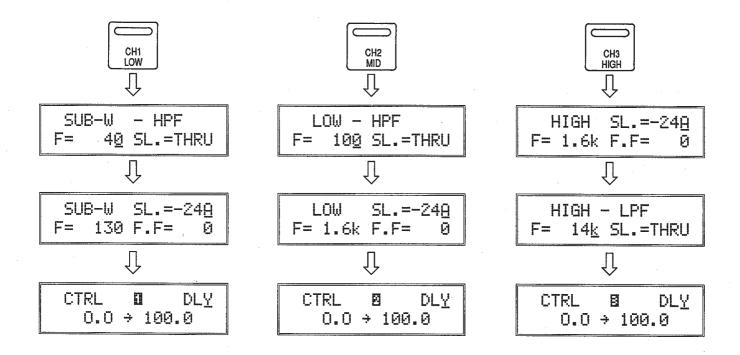
A l'aide des touches de CURSOR  $\lhd$  et  $\triangleright$ , déplacer le curseur au paramètre requis. Régler la valeur du paramètre sélectionné à l'aide des touches  $\triangle$  et  $\nabla$  de modification de paramètres.
