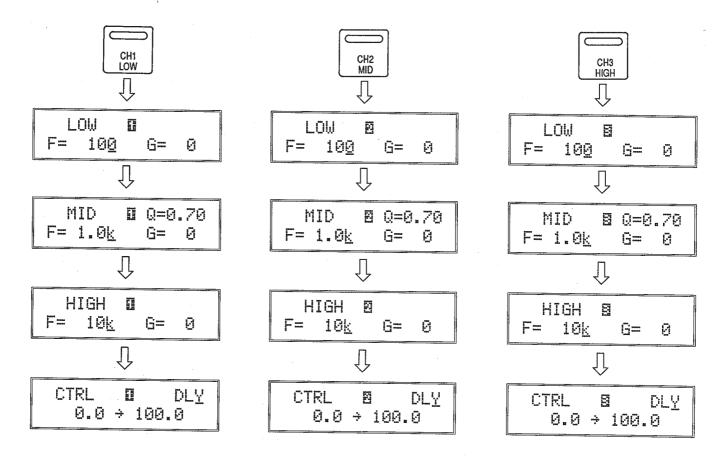
A l'aide des touches de CURSOR  $\triangleleft$  et  $\triangleright$ , déplacer le curseur au paramètre requis. Régler la valeur du paramètre sélectionné à l'aide des touches  $\triangle$  et  $\stackrel{\triangleright}{\nabla}$  de modification de paramètres.
