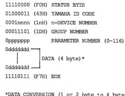
\*DATA CONVERSION (1 or 2 byte to 4 byte) (1 byte)
