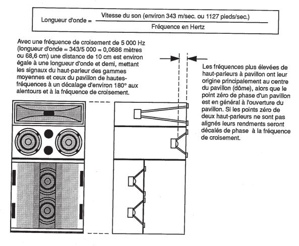
Dans cet exemple, la distance de 10 cm entre le point zéro de phase des haut-parleurs de gammes moyennes et du pavillon de hautes-fréquences entraîne une différence de phase de 180° — le pire cas possible. On remédie facilement à cette situation avec la D1030 au mode RETARD ET CROISEMENT en réglant le retard des gammes moyennes (CH2) à 20 millisecondes environ - ou 68 millimètres si le mode d'affichage est réglé à mètres. Un réglage précis est le mieux fait par oreille.
