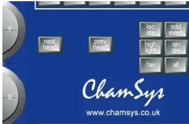
Section de contrôle des appareils
