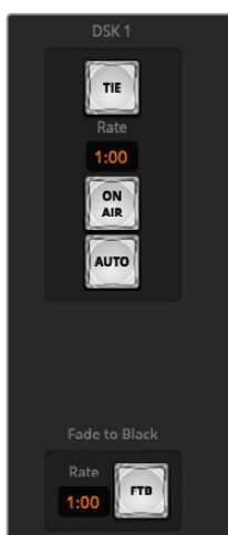
Incrustation en aval et fondu au noir
